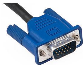
Złącze VGA DB15 Pin 12 – SDA Pin 15 – SCL
